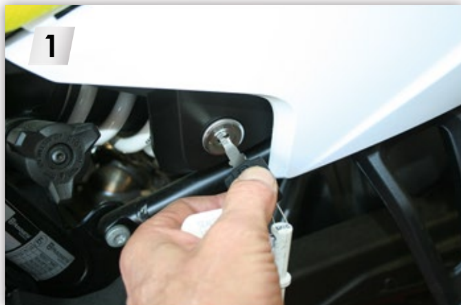
Soziussitz mit Schlüssel entriegeln und abnehmen Unlock with key and remove the passenger seat
