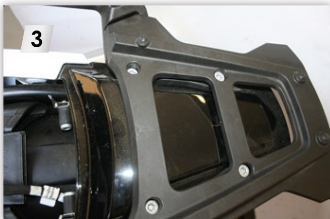
4 x „Torx T45“ lösen und Gepäckbrücke inkl. Abdeckung abnehmen Loosen 4 x "Torx T45" and remove luggage rack including cover
